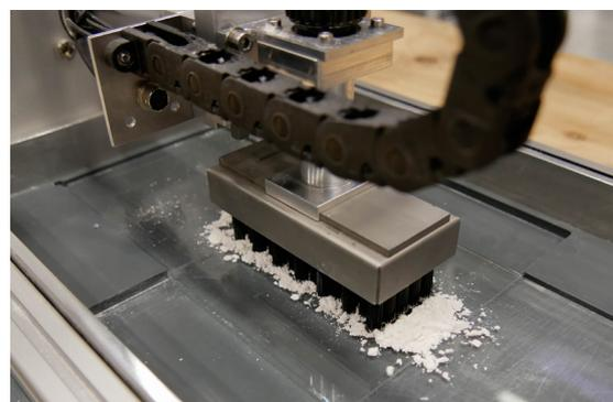
*Abrasionstest mit linearer Bürstenreinigung unter Einfluss eines standardisierten Prüfstaubs.*
