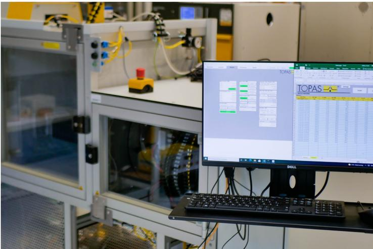
Der mit der Firma Topas entwickelte Soiling-Teststand CST 117 ermöglicht halbautomatisierte Testabläufe nach VDI 3956-1.
